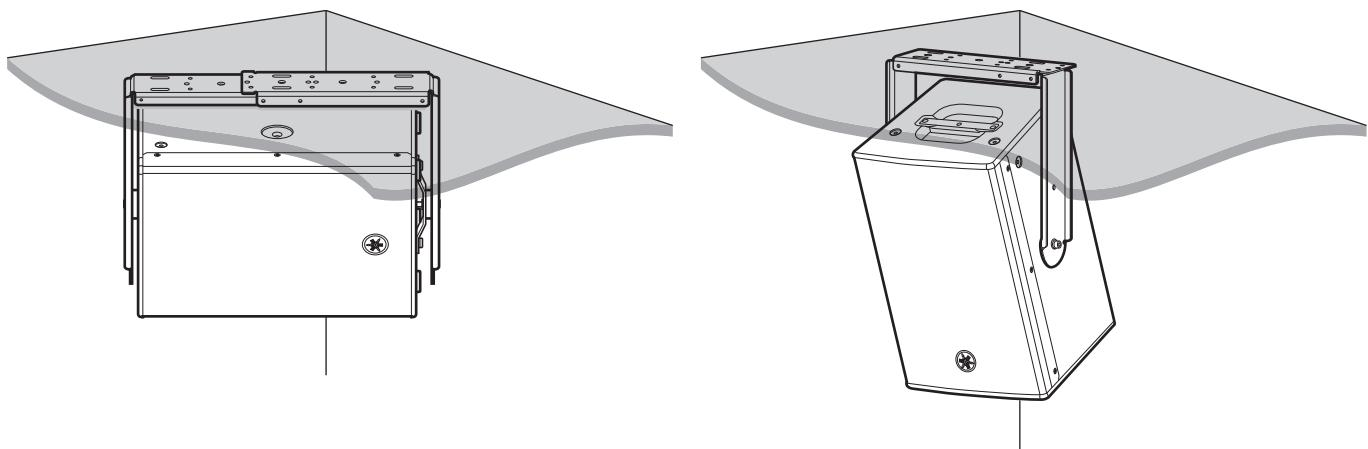
CHR10 можно аккуратно установить на потолке или стене (как горизонтально, так и вертикально) с помощью продаваемого отдельно U-образного кронштейна Yamaha UB-DXRDHR10. Инструкции по установке U-образного кронштейна см. в соответствующем руководстве для UB-DXRDHR10.
