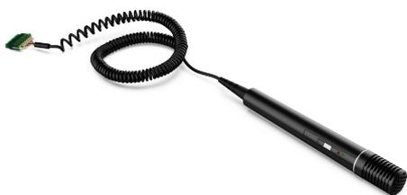
DCNM-FHHC — это узконаправленный конденсаторный микрофон со встроенной защитой от хлопков и дыхания. Удобно помещается в одной руке и имеет кнопку управления. Врезной ручной микрофон со спиральным кабелем устанавливается на сиденьях для участников, где нет места для настольного или врезного монтажа. Микрофон также можно расположить на напольной стойке.
