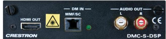
DMC-S-DSP является входной картой, предназначенной для работы в составе любого расширяемого картами коммутатора Crestron® DigitalMedia™. Она содержит один DM 8G® Fiber вход, дополненный выходом аналогового звука и проходным HDMI® выходом. Ко входу DM 8G Fiber можно подключить передатчик DM 8G Fiber или выход другого DM® коммутатора используя одну жилу многомодового оптоволокна [1].
