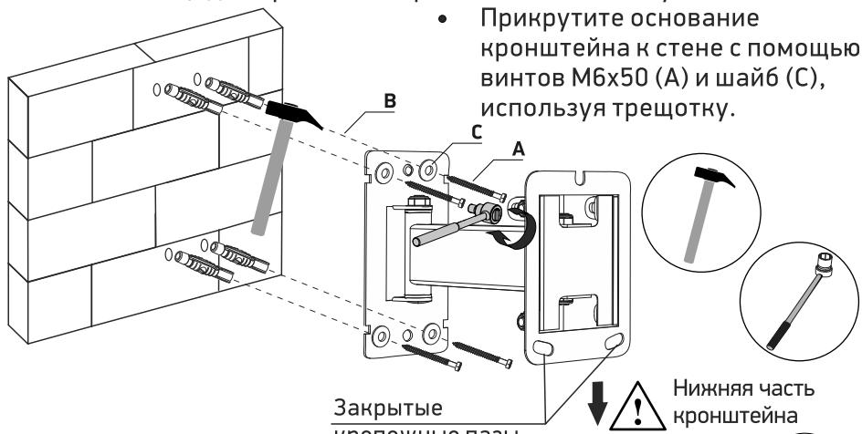
**ВНИМАНИЕ:** Для закручивания шурупов не используйте ключ (K) из комплекта!
