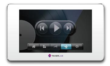
Панель управления Oxygen 5IP состоит из металлического корпуса с сенсорным ёмкостным экраном размером 5,5 дюймов. С экрана удобно управлять аудиопроцессором через локальное сетевое подключение, есть возможность монтажа в стену. Обеспечивает управление сценариями, регулировку громкости, управление воспроизведением и более обширные настройки по желанию.
