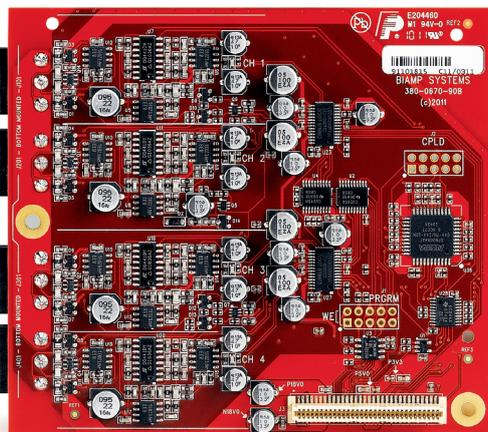
Tesira® EOC-4 — это карта расширения с 4 аналоговыми выходами, предназначенная для использования с устройством Tesira EX-MOD. EOC-4 является одной из трех карт расширения для установки в Tesira EX-MOD. Каждая карта EOC-4 имеет 4 выхода с микрофонным или линейным уровнем сигнала. Выходы симметричные и реализованы на клеммных разъемах. Программное обеспечение позволяет управлять параметрами каждого выхода, в том числе заглушением, уровнем, поворотом фазы и максимальным выходным сигналом.
