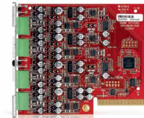
Tesira® SIC-4 — модульная карта аналоговых входов для использования с устройствами Tesira SERVER или SERVER-IO. Каждая карта SIC-4 имеет 4 микрофонных/линейных входа. Входы симметричные и реализованы на клеммных разъемах. ПО Tesira позволяет управлять уровнем сигнала каждого входа с индикацией перегрузки, включать фантомное питание +48 В, регулировать уровень, а также инвертировать и заглушать сигнал.
