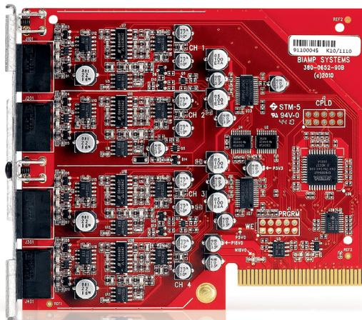
Tesira® SOC-4 – модульная карта аналоговых выходов для использования с устройствами Tesira SERVER или SERVER-IO. Каждая карта SOC-4 имеет 4 микрофонных или линейных выхода. Выходы симметричные и реализованы на клеммных разъемах. Программное обеспечение позволяет управлять параметрами каждого выхода, в том числе заглушением, уровнем, поворотом фазы и уровнем выходного сигнала.
