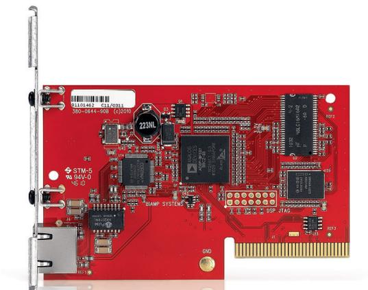
Tesira® SVC-2 – модульная карта для передачи голоса по протоколу Internet (VoIP), предназначенная для использования с устройствами Tesira SERVER или SERVER-IO. Карта SVC-2 позволяет системе Tesira напрямую подключаться к системам IP-телефонии. При использовании с функцией автоматического эхоподавления система Tesira становится необычайно мощной, универсальной и доступной платформой для конференц-связи.
